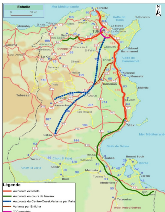
Figure 7.5: Projet de l'autoroute du Centre-Ouest
